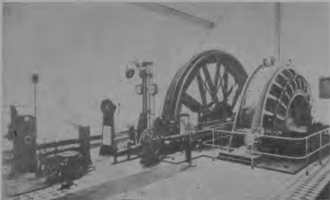
49. Maszyna wyciągowa z kopalni „Wujek” w Katowicach
