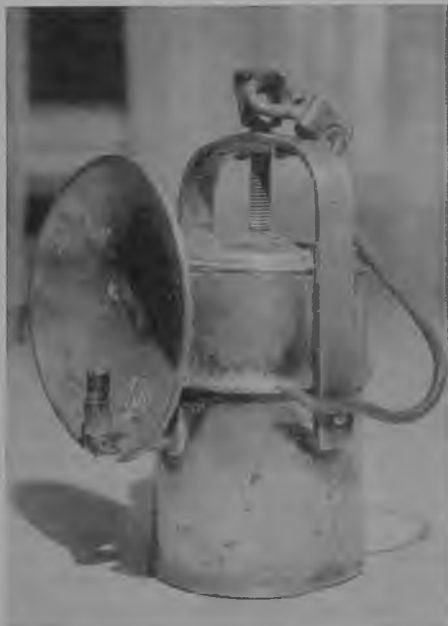
33. Górnicza lampa karbidowa z reflektorem
