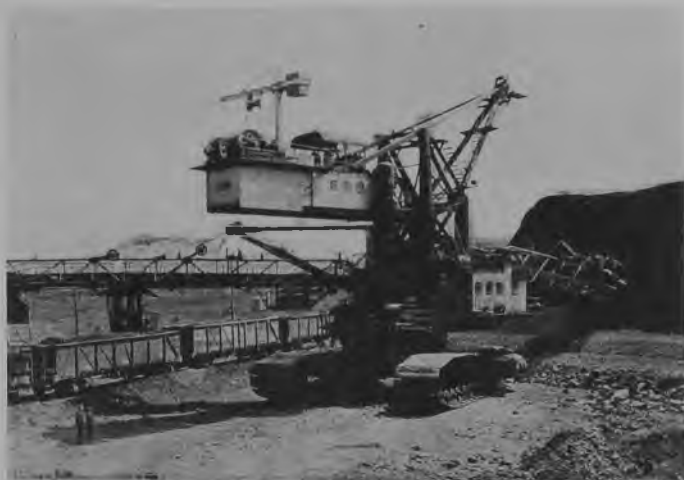
69. Koparka kołowa ERG-400 D, zastosowana w 1970 r. w Zagłębiu Ekibastuskim w ZSRR
