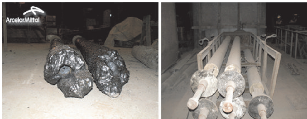
Rys. 34. Składowisko zużytych i zapasowych lanc do wdmuchiwania argonu
